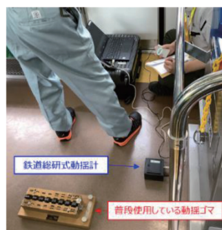
写真1 列車動揺測定
