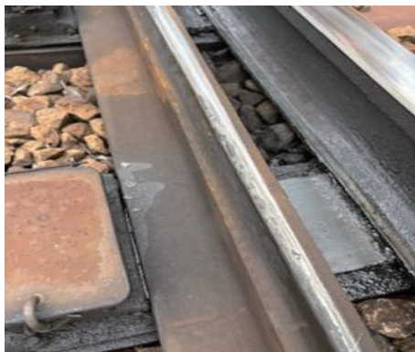
図10 シェリング傷の発生、剥離傷
